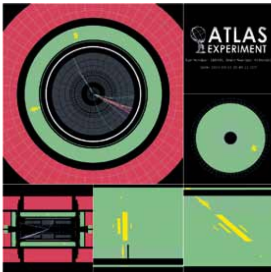
Un événement contenant deux photons dans l'état final, une des signatures possibles du boson de Higgs. Les photons sont identifiés par deux amas d'énergie dans le calorimètre.
